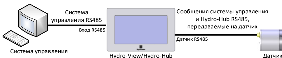
Рисунок 18: Hydro-View / Hydro-Hub, Коммутация интерфейса RS485
