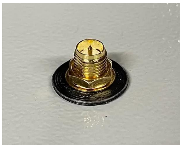
Figura 9: Cabo de extensão da antena instalado
