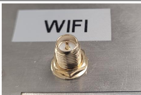
Figura 6: Connettore dell'antenna Wi-Fi
