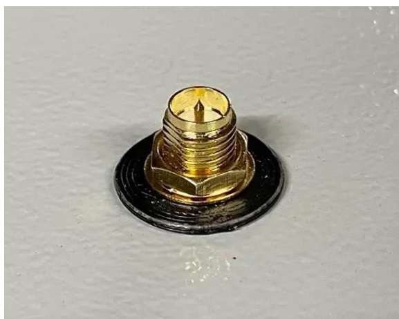
Figura 9: Cavo di prolunga dell'antenna installato
