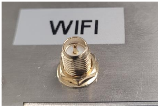
Figure 6 : Connecteur de l'antenne Wi-Fi
