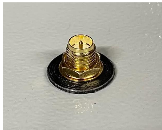
Figure 9 : Câble d'extension de l'antenne installé
