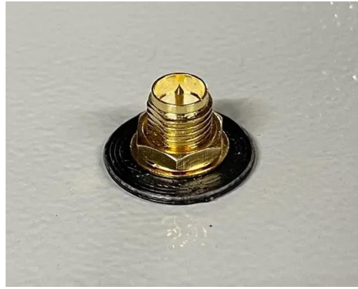
Abbildung 9: Installiertes Verlängerungskabel der Antenne
