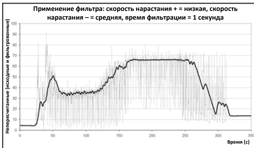
Рисунок 7: Фильтрация ИСХОДНОГО непересчитанного сигнала (1)
