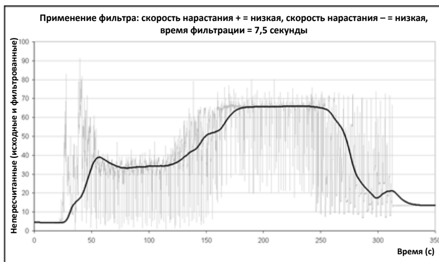
Рисунок 8: Фильтрация ИСХОДНОГО сигнала (2)
