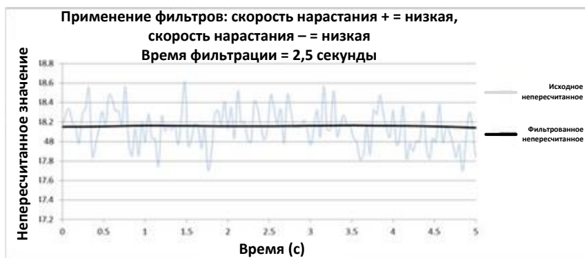
Рисунок 4: График, показывающий фильтрованный сигнал
