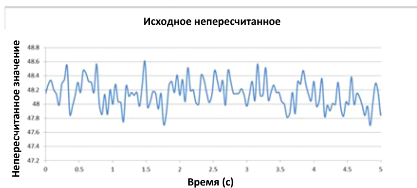
Рисунок 3: График влажности сыпучего материала по исходным непересчитанным показаниям
