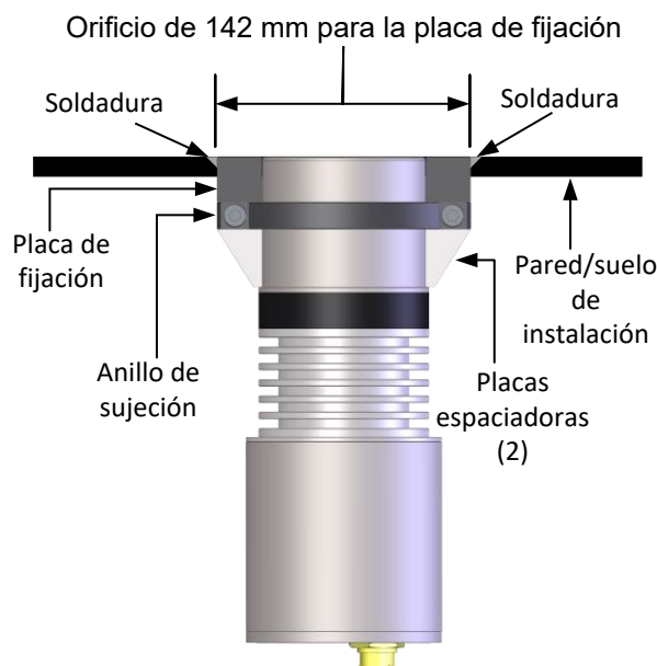
Ilustración 19: Instalación del sensor (placa de fijación con montaje empotrado)
