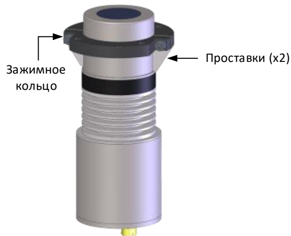
Рисунок 31: Зажимное кольцо (утопленный монтаж)
