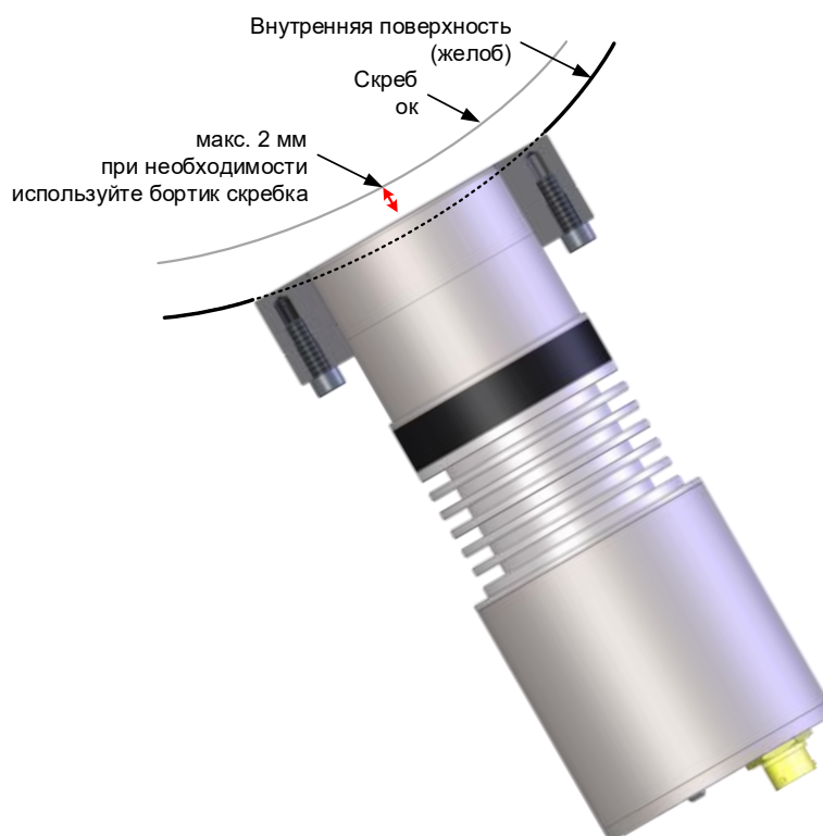
Рисунок 10: Зазор между датчиком и скребком
