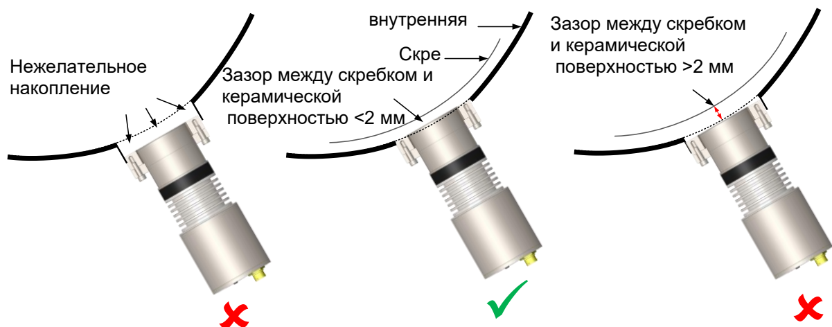
Рисунок 4: Установка на изогнутой поверхности
