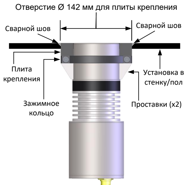
Рисунок 19: Установка датчика (монтаж плиты крепления заподлицо)
