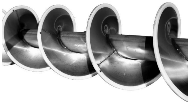
Рисунок 11: Бортик скребка на шнековом конвейере
