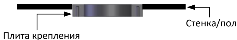
Рисунок 30: Монтаж плиты крепления заподлицо
