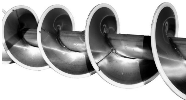
Figura 11: Rebordo de pala num transportador helicoidal
