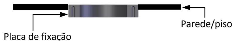
Figura 30: Placa de fixação montada à face
