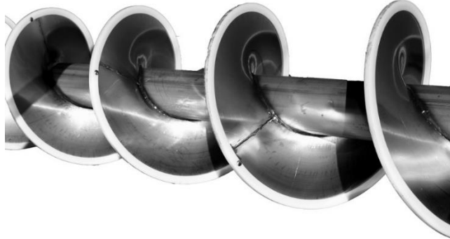
Figure 11 : Bordage de spire sur convoyeur à vis
