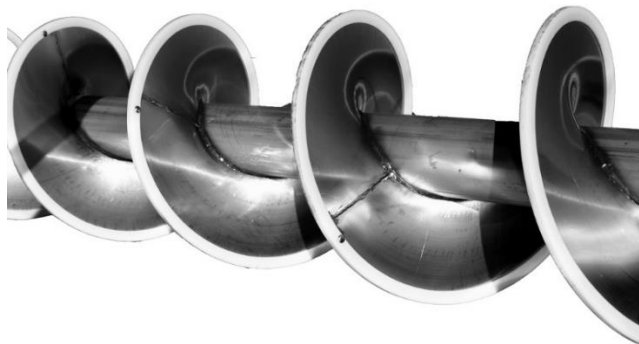
Figura 11: Bordatura dell'elica in un trasportatore a coclea
