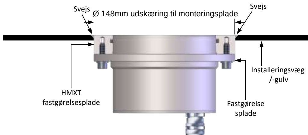
Fig. 19: Sensorinstallering (fastgørelsesplade)
