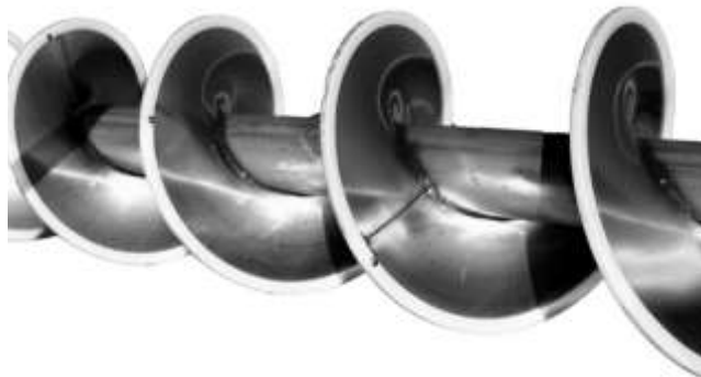
Fig. 11: Snegleliste på en skruetransportør
