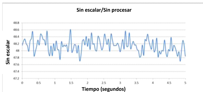
Ilustración 3: Rastro de humedad sin escalar/sin procesar en el material que fluye
