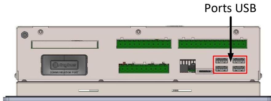
Figure 78 : Emplacement des ports USB
