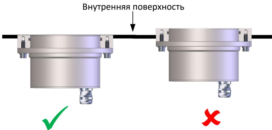
Рисунок 2: Установка на плоской поверхности
