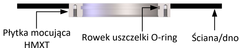
Rysunek 14: Płyta mocująca zamontowana na równo z powierzchnią
