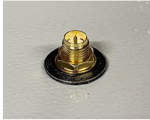
Abbildung 9: Installiertes Verlängerungskabel der Antenne
