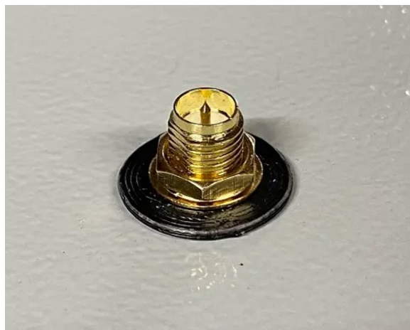
Figura 9: Cabo de extensão da antena instalado
