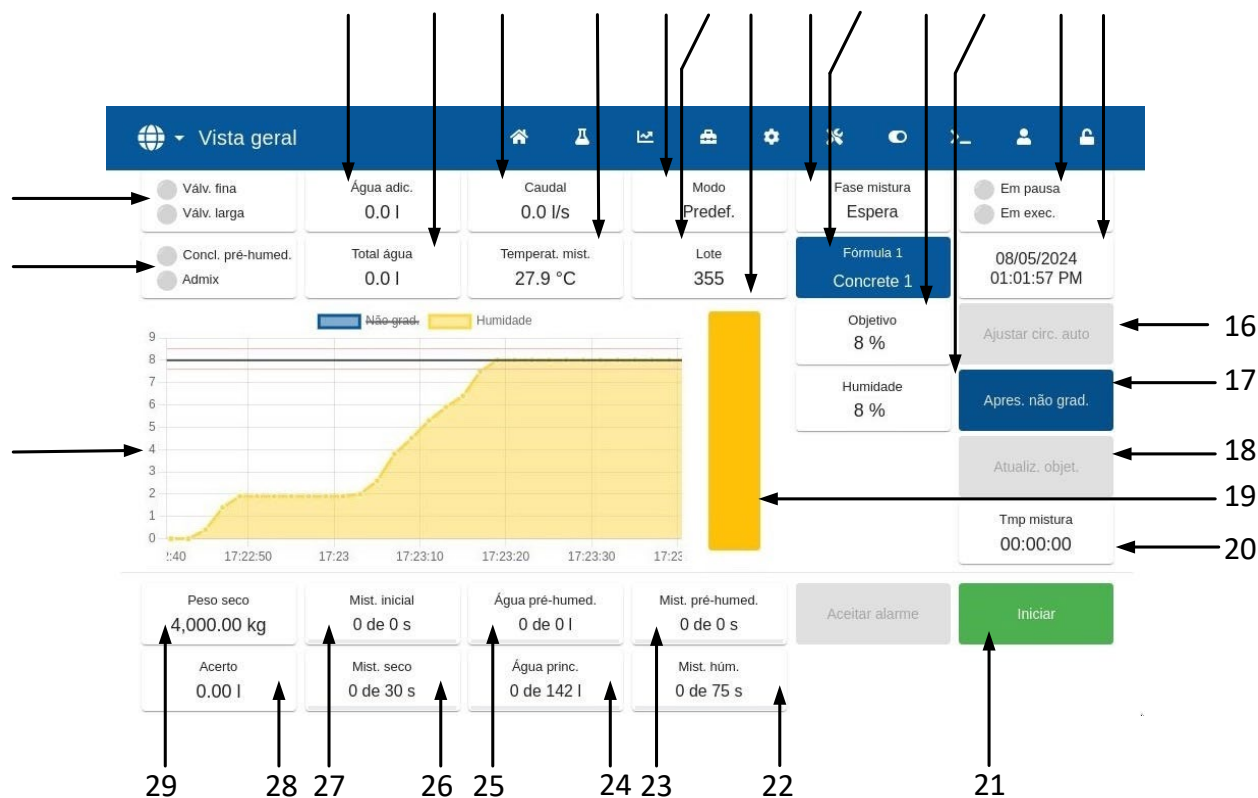
Figura 6: O ecrã de vista geral do Hydro-Control
