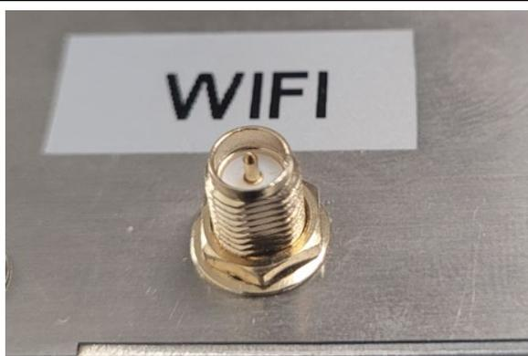
Figura 5: Connettore dell'antenna Wi-Fi
