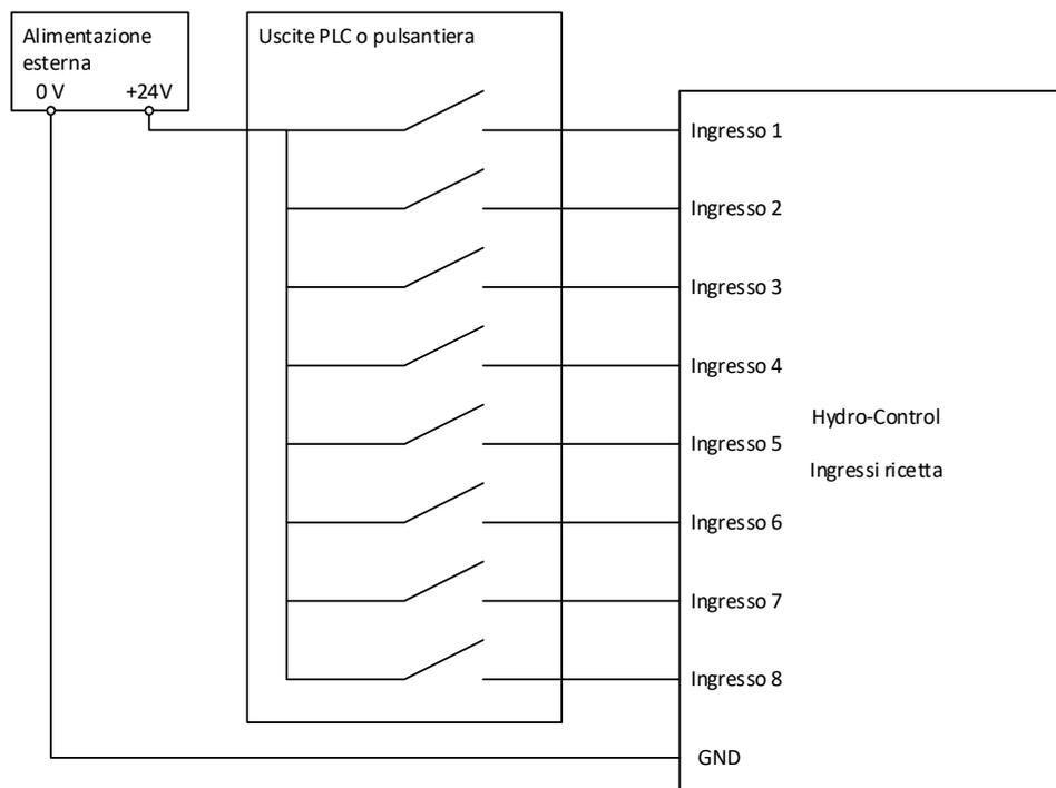
Figura 24: Cablaggio di ingressi di selezione delle ricette
