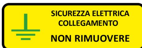
La messa a terra del sistema è fondamentale per il corretto funzionamento del dispositivo. È vietato installare o utilizzare il dispositivo Hydro-Control (Modello HC07-110) senza aver collegato la messa a terra. La Figura 10 indica il punto di messa a terra del dispositivo.
