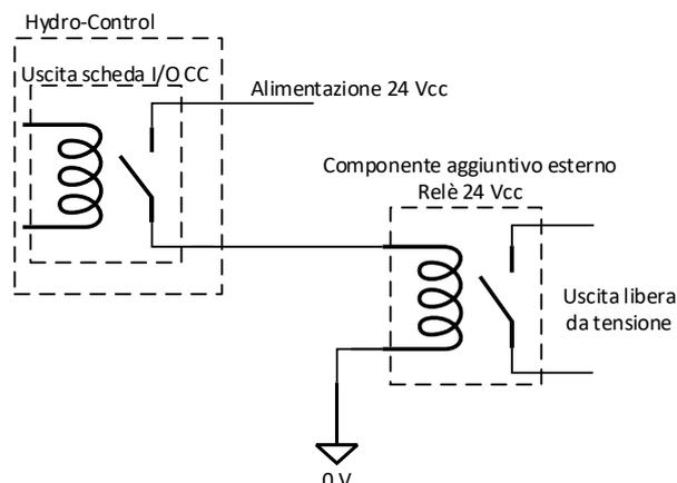
Figura 17: Attivazione di un dispositivo CA utilizzando un'uscita di scheda I/O CC
