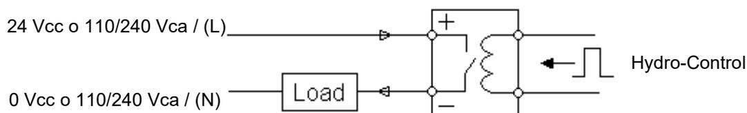
Figura 14: Schema di cablaggio delle uscite digitali
