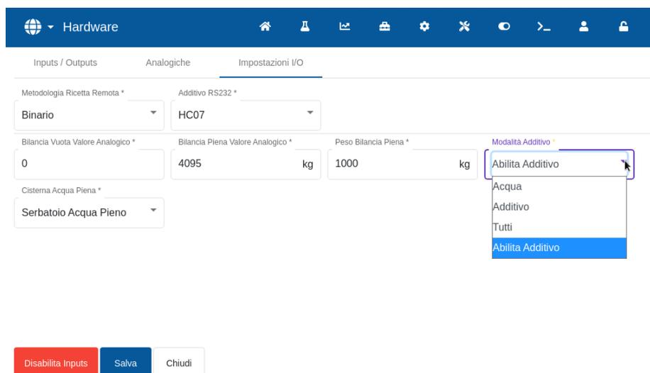
**Figura 31: Configurazione dell'uscita Additivo**
