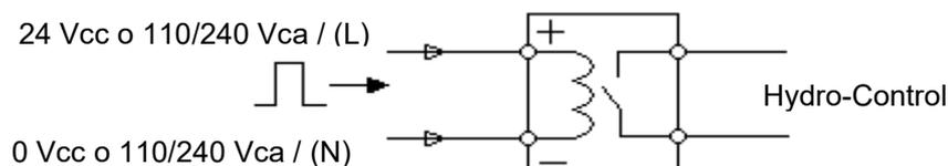
Figura 13: Schema di cablaggio degli ingressi digitali
