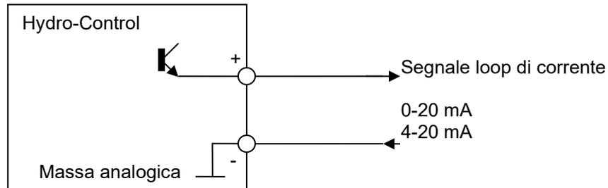
Figura 23: Schema di cablaggio delle uscite analogiche
