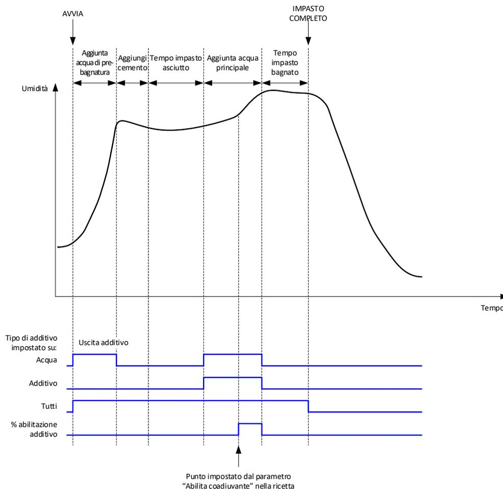
**Figura 72: Segnale di uscita additivo durante un ciclo d'impasto normale**
