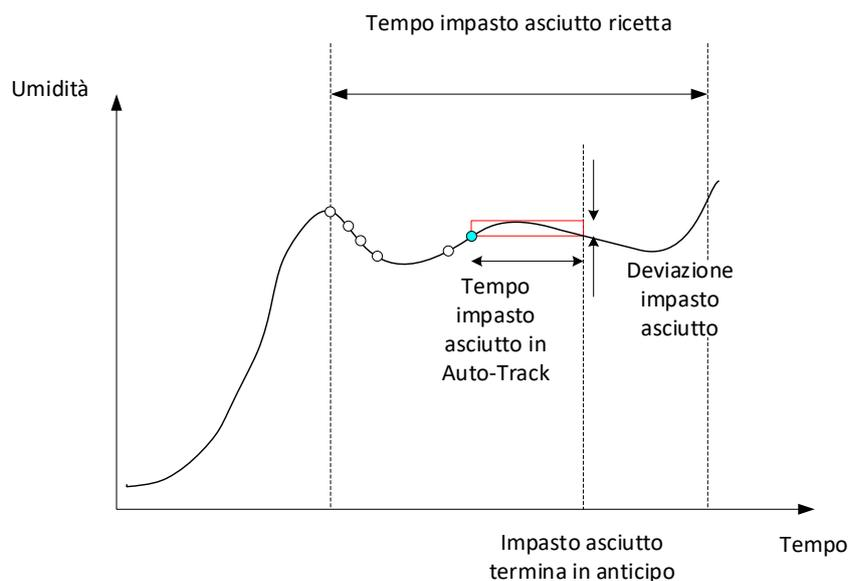
**Figura 75: Esempio di parametro Auto-Track per la fase d'Impasto asciutto**
