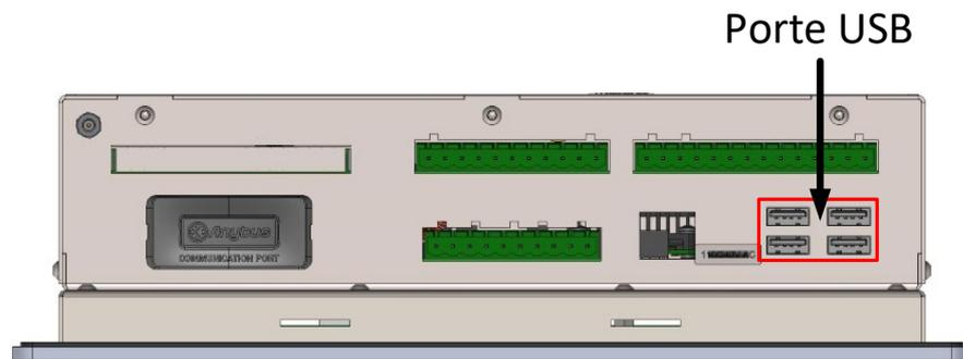
Figura 77: Posizione delle porte USB
