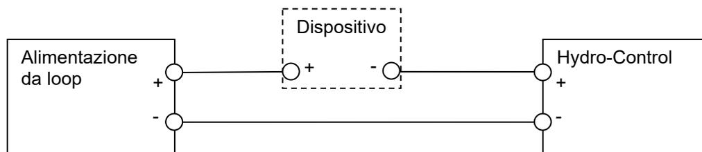
**Figura 20: Collegamento di dispositivo alimentato da loop**
