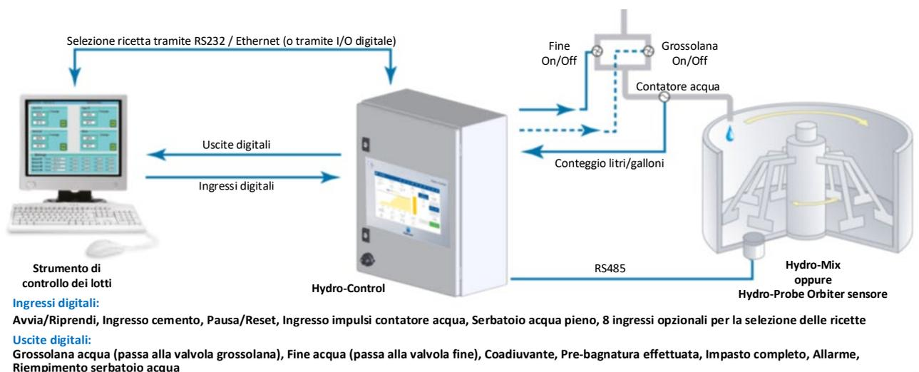
Figura 2: Esempio di implementazione di Hydro-Control
