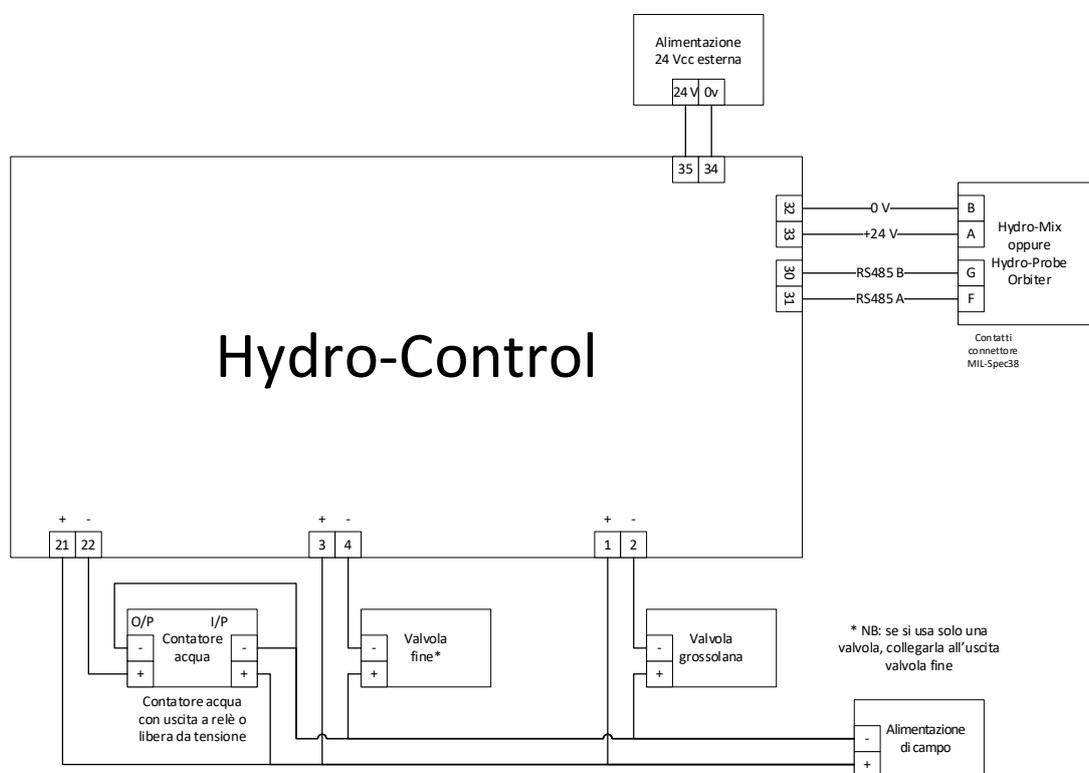
Figura 68: Esempio di schema di cablaggio per il funzionamento manuale dell'impianto
