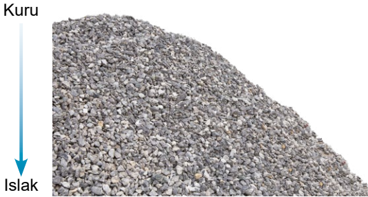
Şekil 1: Agregata Yığınlarında Doğal Nem Drenajı
