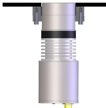
**Рисунок 21: Конечная позиция датчика**
