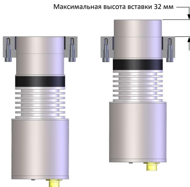
Рисунок 18: Вставка с минимальной и максимальной высотой
