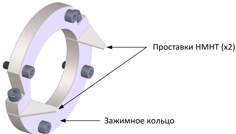
Рисунок 15: Проставки HMHT
