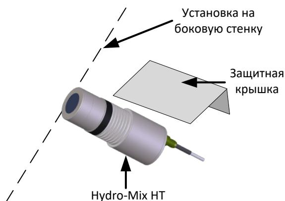
Рисунок 28: Hydro-Mix HT с защитной крышкой
