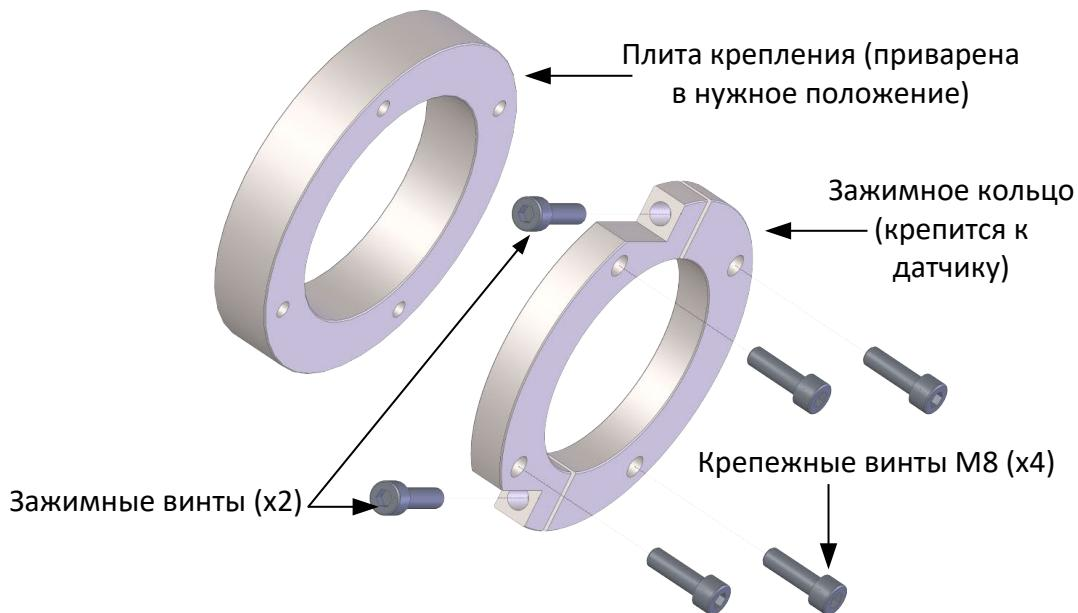
Рисунок 12: Монтажные элементы Hydro-Mix HT
