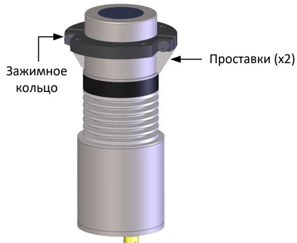
**Рисунок 23: Зажимное кольцо (утопленный монтаж)**
