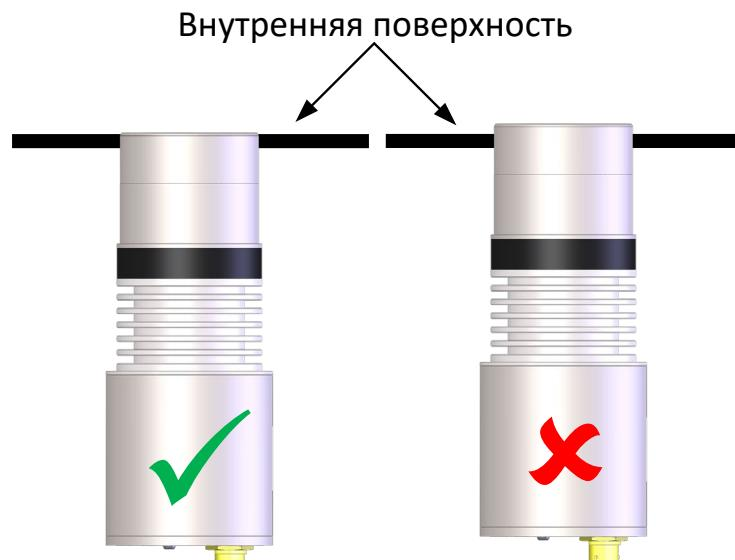
**Рисунок 2: Установка на плоскую поверхность
