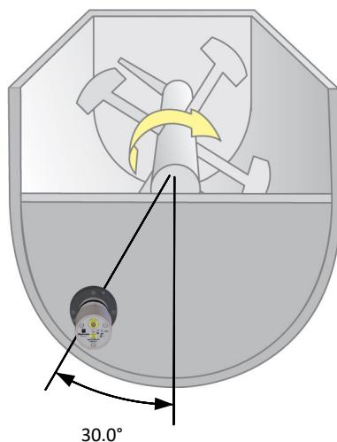
**Рисунок 5: Установка одновального смесителя для органических материалов**
