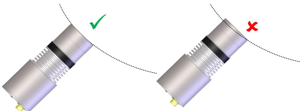
Рисунок 3: Установка на изогнутую поверхность
