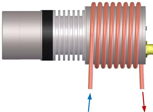
Рисунок 26: Водяное охлаждение
