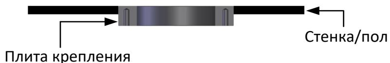
**Рисунок 22: Монтаж плиты крепления заподлицо**
