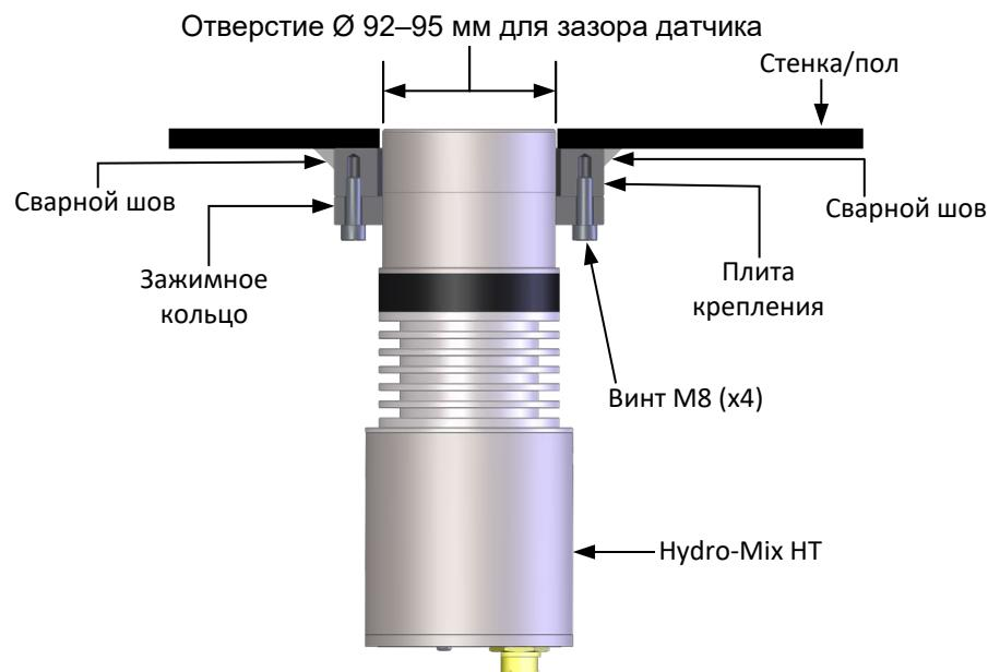
Рисунок 10: Установка датчика (наружный монтаж плиты крепления)
