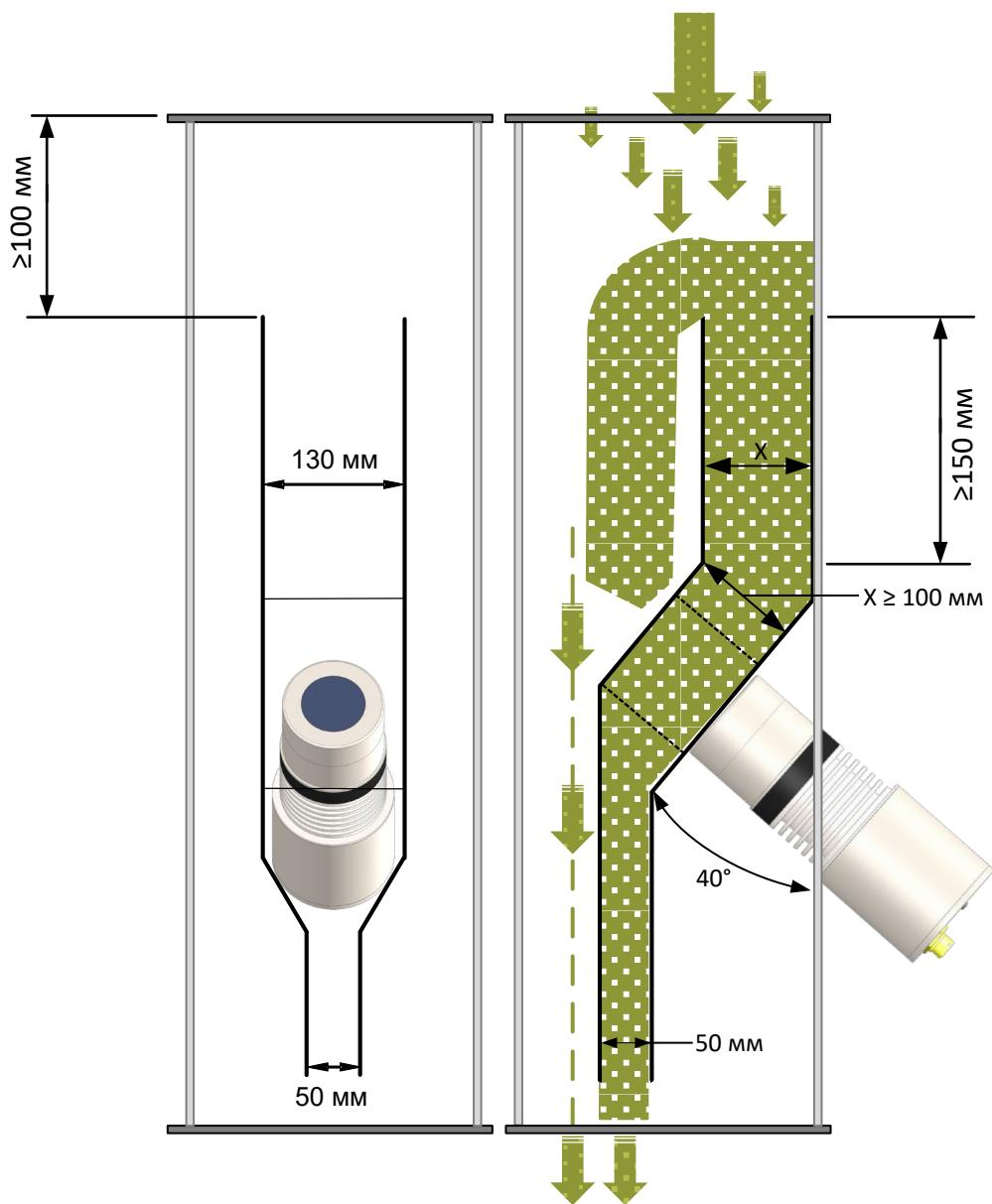
Рисунок 9: Интеграция Hydro-Mix HT в трубопровод
