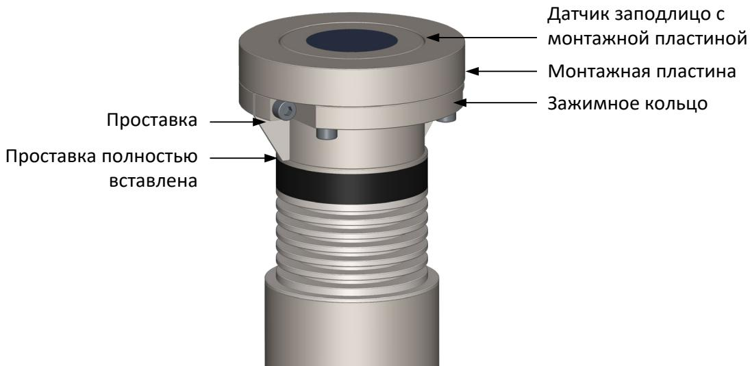
Рисунок 17: Окончательная сборка с установленной плитой крепления
