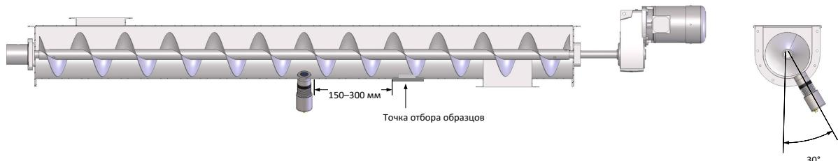
**Рисунок 6: Установка в шнековом конвейере**
