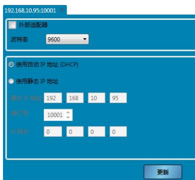
图 115: 以太网适配器配置
