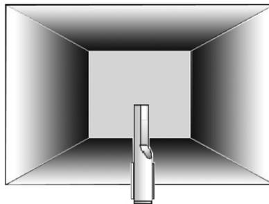
图 4: 安装在料箱中的 Hydro-Probe 的俯视图
