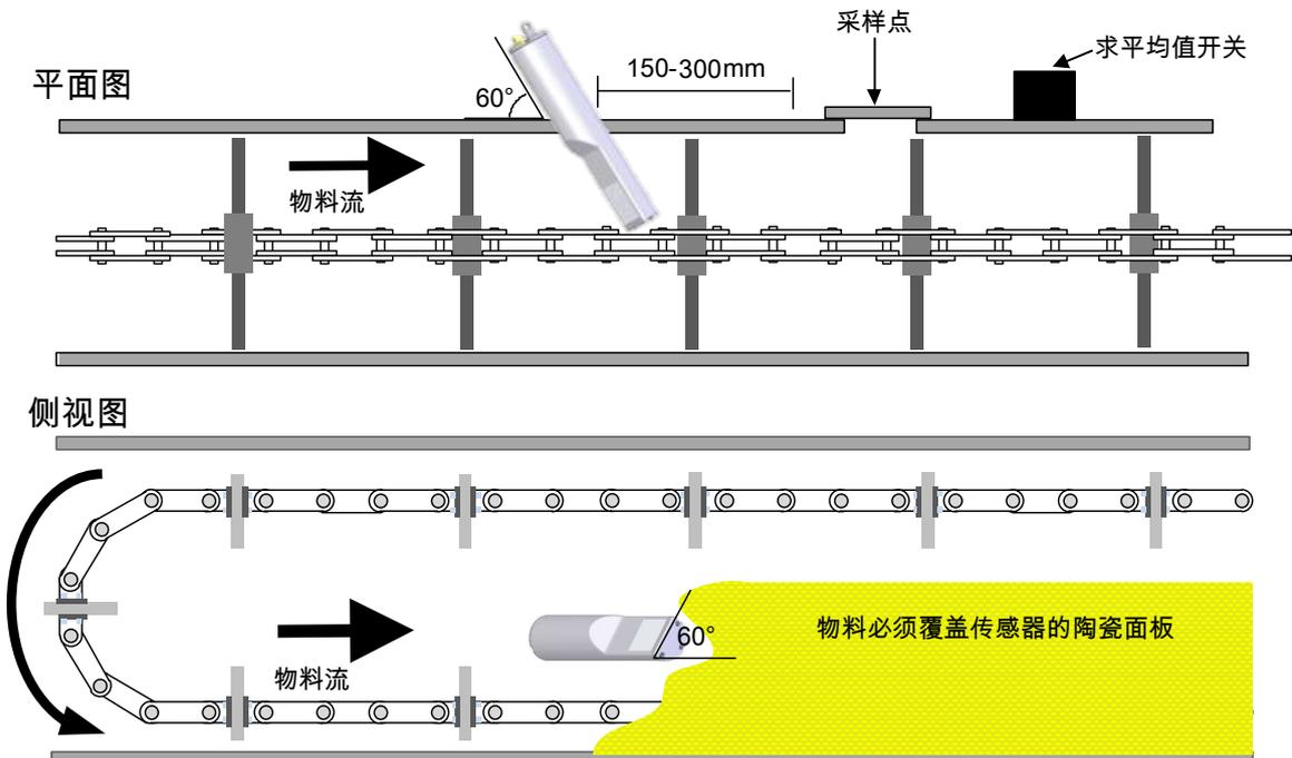
图 11: 在埋刮板输送机中安装 Hydro-Probe
