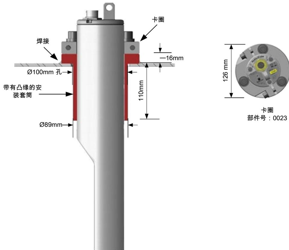
图 16: 带有凸缘的安装套筒（部件号 0024A）
