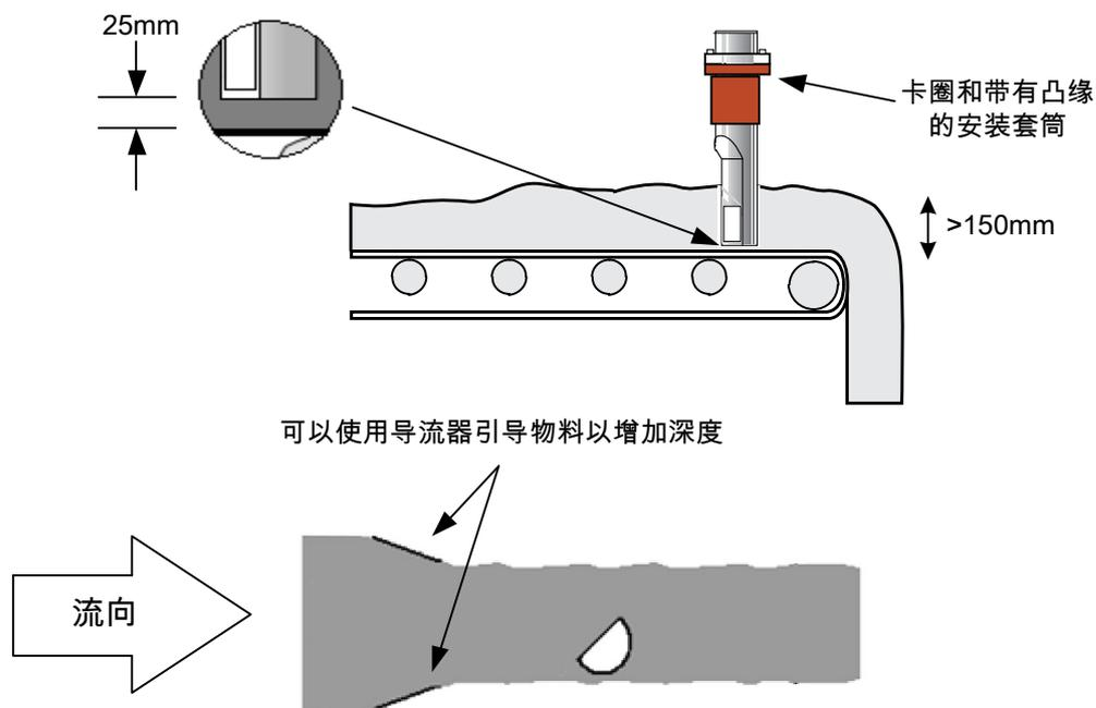
图 9: 在传送带上安装 Hydro-Probe
