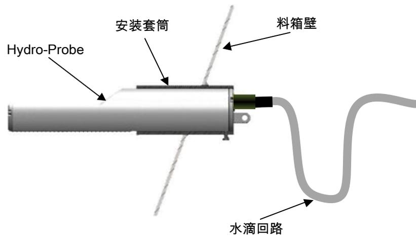
图 19: 安装了水滴回路的 Hydro-Probe
