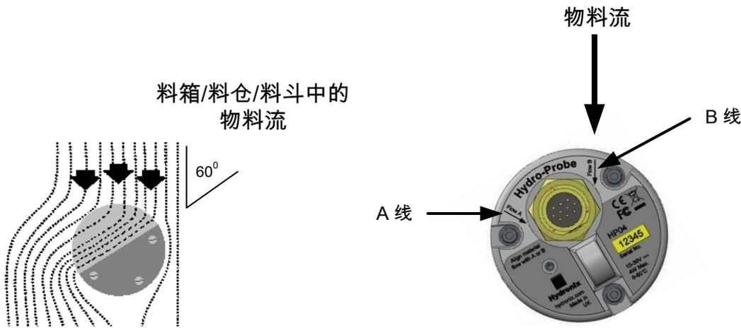
图 2: Hydro-Probe 安装角度和物流
