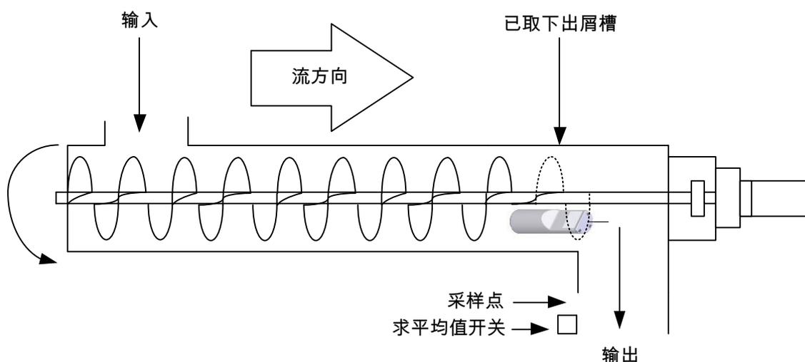
图 12: 在螺旋输送机中安装 Hydro-Probe
