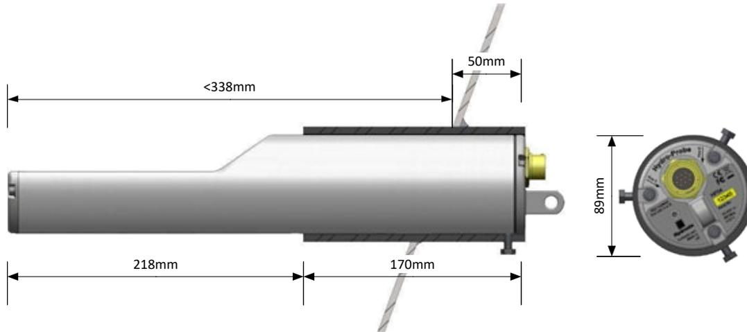
图 14: 标准安装套筒（部件号 0025）
