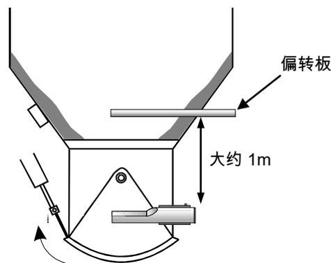
图 3: 安装偏转板以防止损坏
