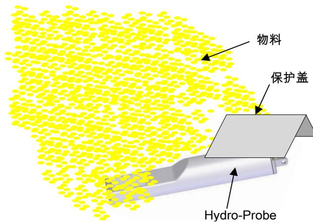
图 20: Hydro-Probe 保护盖
