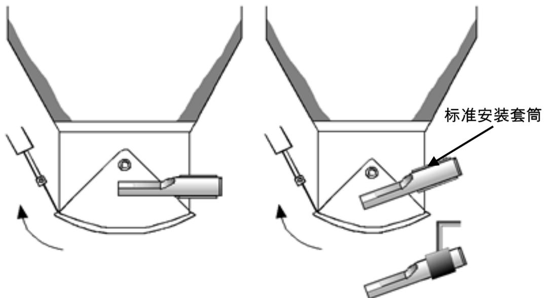
图 5: 在料箱颈部安装 Hydro-Probe
