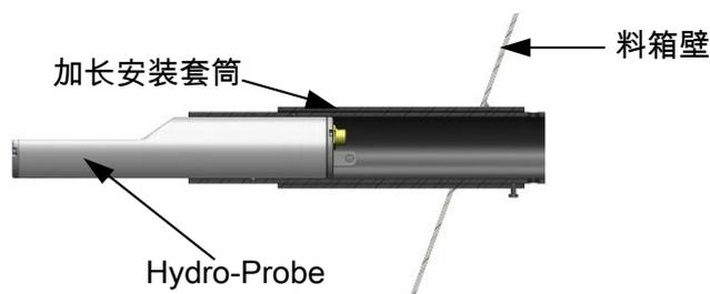
图 18: 安装在加长安装套筒中的 Hydro-Probe
