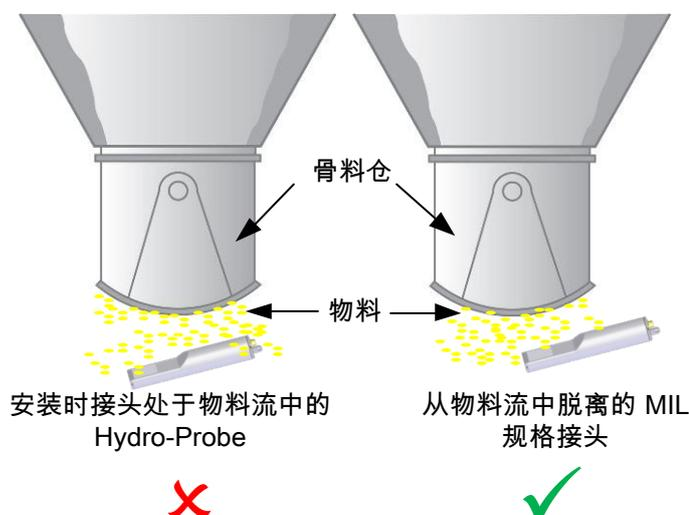
图 17: 安装在骨料仓下方的 Hydro-Probe
