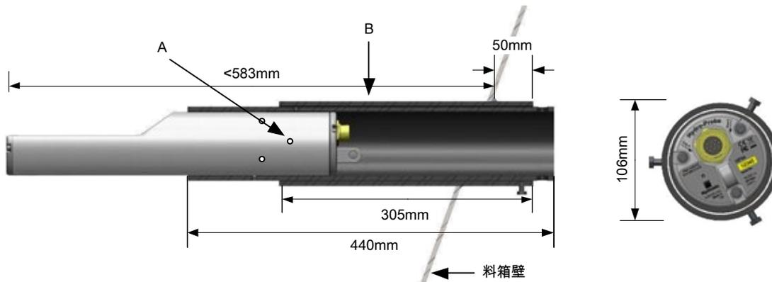
A – 用 6 个六角螺丝（使用 Loctite 或类似产品）以螺纹连接方式将传感器固定在内套筒上
