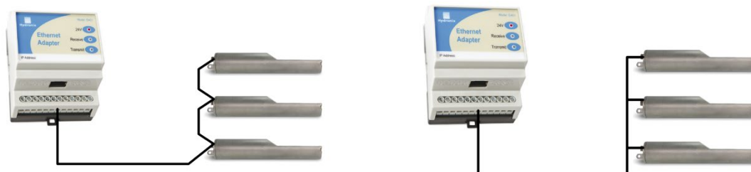
図 22: 正しい RS485 ケーブルネットワーク
