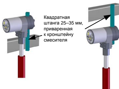
Рис 3: Крепление датчика над или под кронштейном лопасти смесителя
