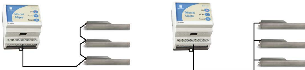
Рис 31: Правильные кабельные соединения сети RS485
