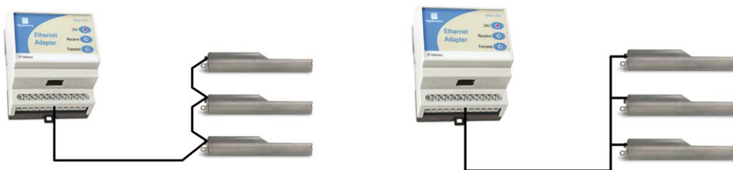
Figura 31: Reti corrette del cavo RS485
