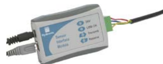
Figura 37: Collegamenti del convertitore SIM01A USB-RS485 (SIM01A)
