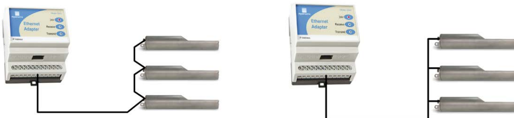
Figure 31: Réseaux de câble RS485
