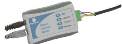
Figure 37: Connexions du convertisseur USB/RS485 SIM01A (SIM01A)
