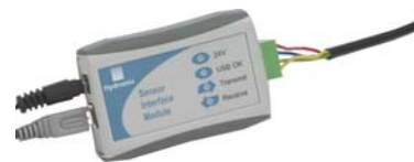
Abbildung 37: SIM01A USB-auf-RS485-Wandleranschlüsse (SIM01A)
