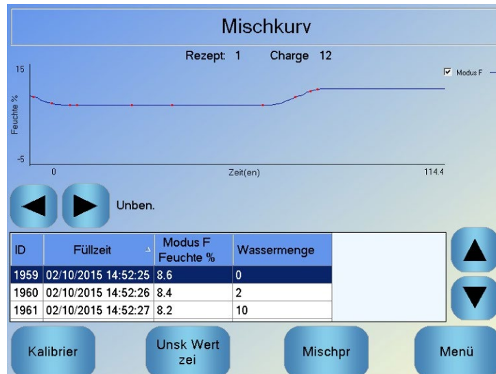
Abbildung 33: Die Mischkurvenanzeige (Feuchtesatz)
