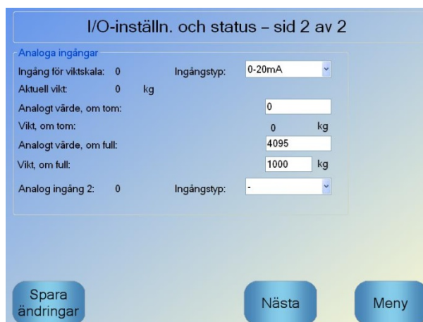
Figur 27: Konfigurationssidan för vägning av vatten.
