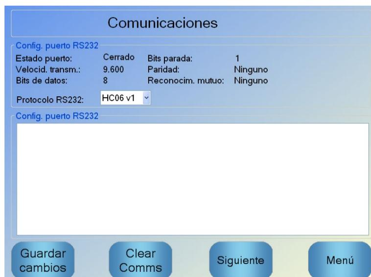
**Figura 48: Pantalla Comunicaciones remotas de RS232**
