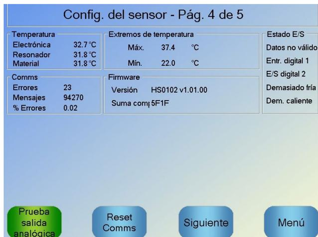
**Figura 31: La pantalla de configuración del sensor – Página 4**
