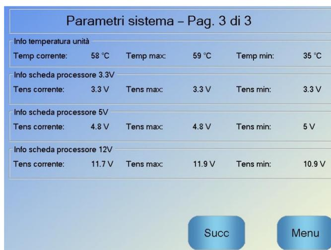
**Figura 26:** La schermata di monitoraggio della tensione e della temperatura
