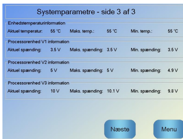
Billede 26: Skærmen for overvågning af spænding og temperatur
