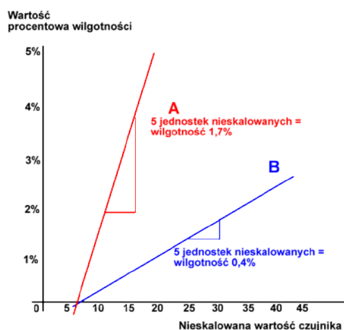
Rys. 36. Relacje między wartościami nieskalowanymi i wilgotnością.
