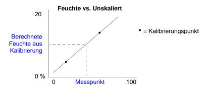
Die Gleichung der durch die Kalibrierpunkte gezogenen Linie dient zur Berechnung des "wahren" Feuchtegehalts aus dem unskalierten Wert. Diese Gleichung ist durch eine Steilheit (B) und einen Offset (C) gekennzeichnet. Diese Werte bilden daher Kalibrierkoeffizienten und können ggf. im Sensor gespeichert werden. Die Umwandlung auf den prozentualen Feuchtegehalt erfolgt folgendermaßen:
