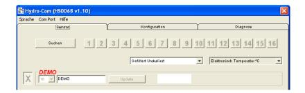
Die im RS485 Netzwerk erkannten Sensoren haben jeweils eine eigene Adresse, die auf der Schaltfläche des aktiven Sensors angezeigt wird (siehe folgende Abbildung). Es können bis zu 6 aktive Sensoren gleichzeitig angezeigt werden.
