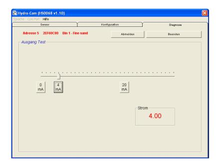
Auf diese Weise kann die Funktion des Analogausgangs geprüft werden oder die Schnittstelle beispielsweise für eine Batch-SPS oder eine externe Anzeige kalibriert werden.
