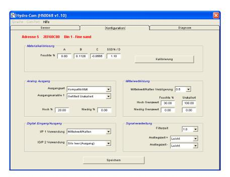
Auf der Konfigurationsseite können die Sensorparameter entsprechend der Anwendung geändert werden. Mögliche Änderungen sind Optimierung der Filterwerte bzw. Mittelwertbildung und das Einrichten des Analogausgangs.
