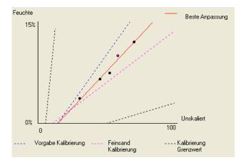
Kalibrierkurve - Feuchte % vs. Unskaliert : Die Kalibrierdaten werden in grafischer Form zusammen mit den beiden Standardsandkalibrierungen und den von Hydronix definierten Kurven maximaler und minimaler Steilheit dargestellt (weitere Informationen finden Sie in Anhang A).
