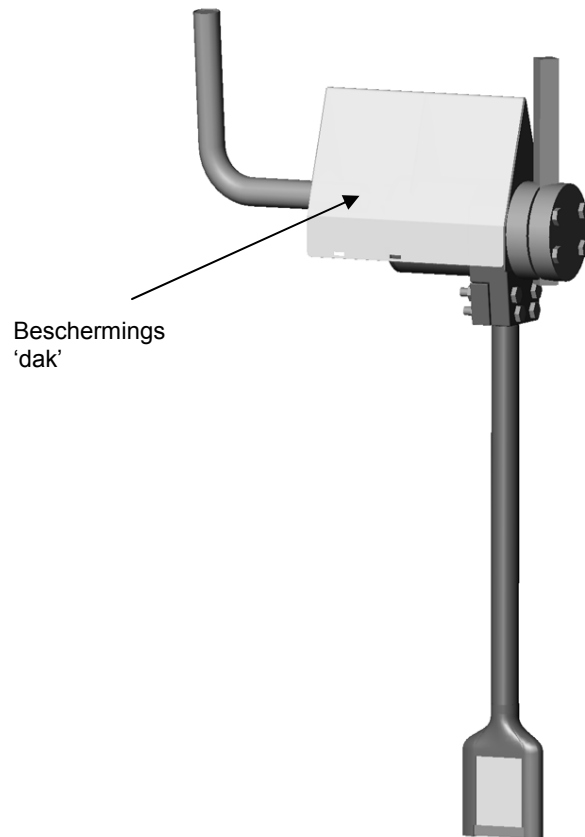
Figuur 5 – Bescherminings 'dak' over de sensor body geplaatst
