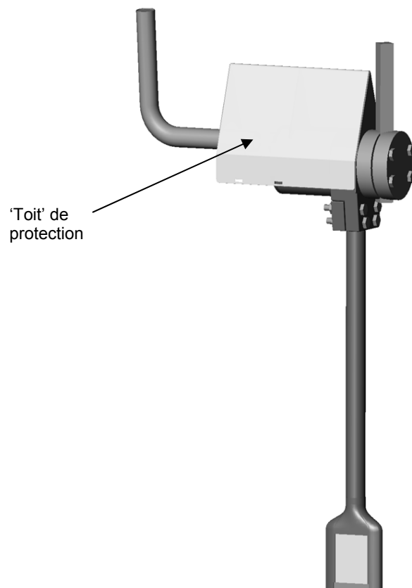
Figure 5 – 'Toit' de protection place au-dessus du corps de la sonde
