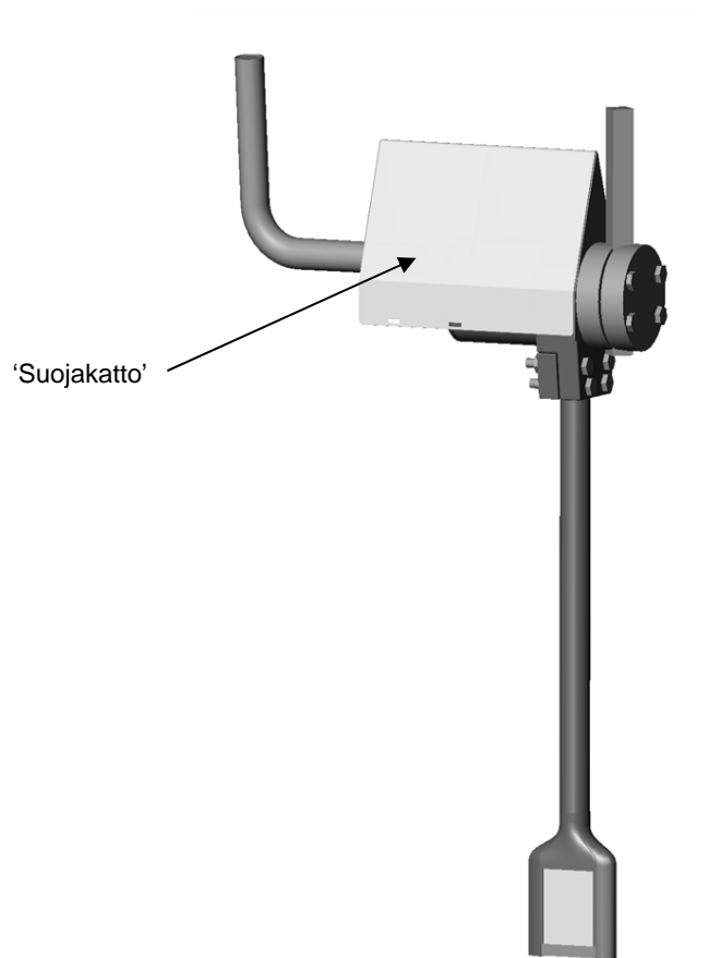
Kuva 5 – 'Suojakatto' anturin kotelon yläpuolella
