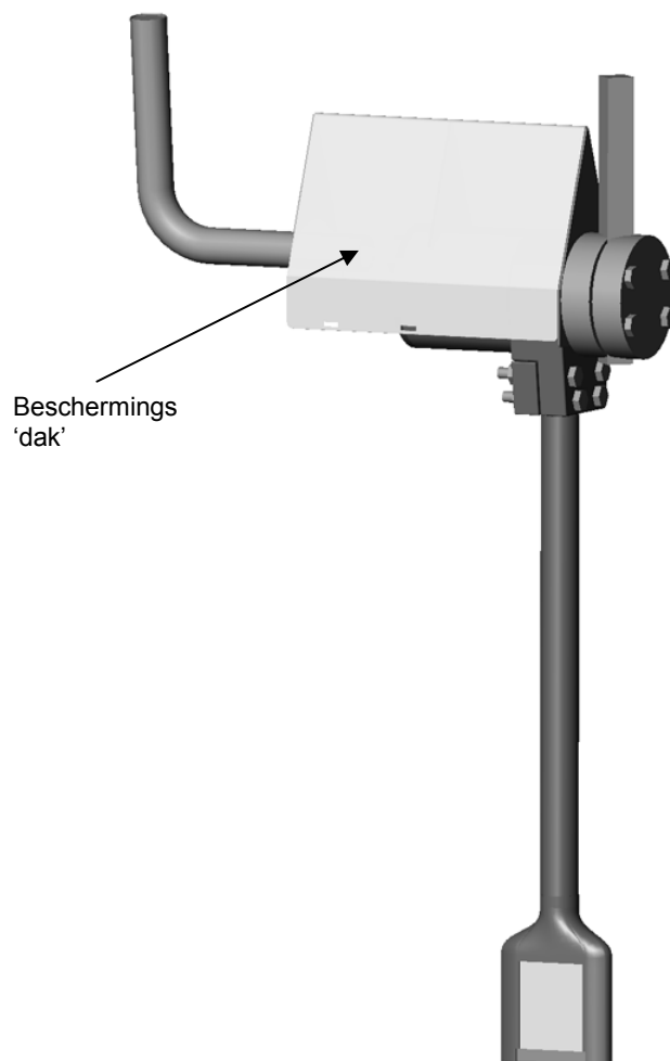
Figuur 5 – Beschermings 'dak' over de sensor body geplaatst
