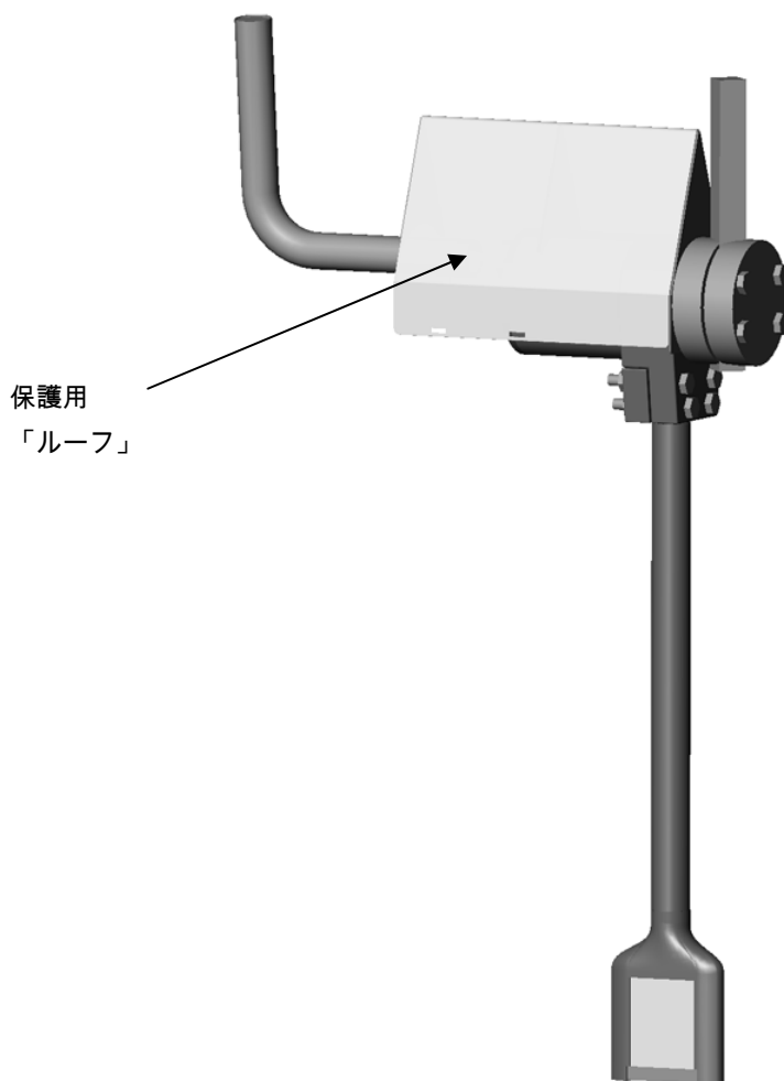
図5 センサー本体上に配した保護用「ルーフ」
