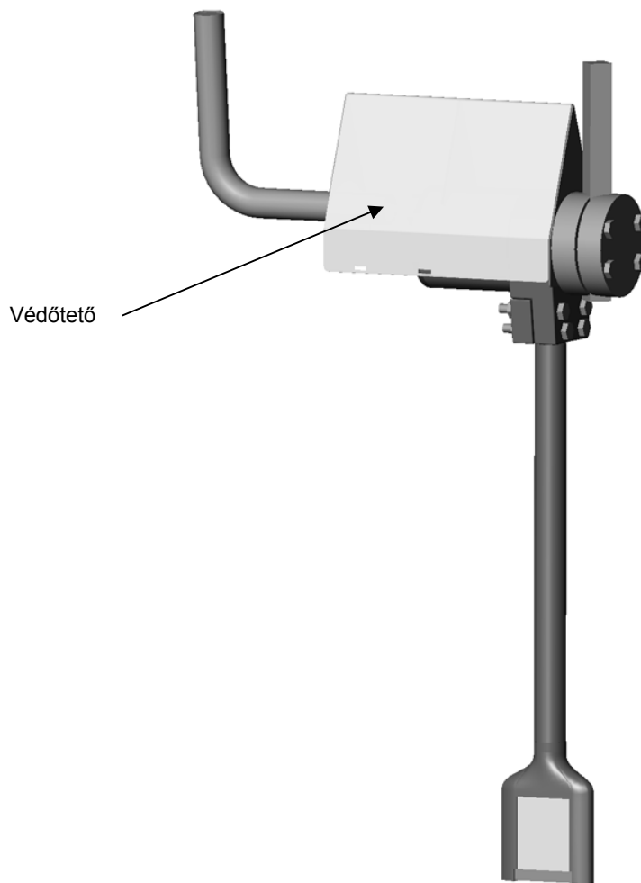
5. ábra - Védőtető az érzékelőházon
