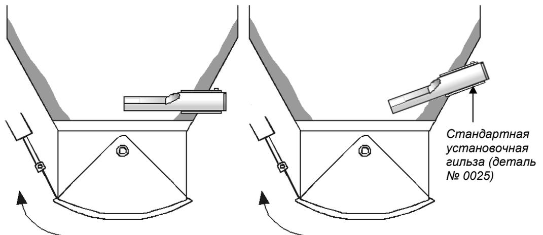
Рисунок 7. Монтаж датчика Hydro-Probe II в стенке бункера
