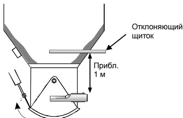
Рисунок 4. Установка защитного отклоняющего щитка
