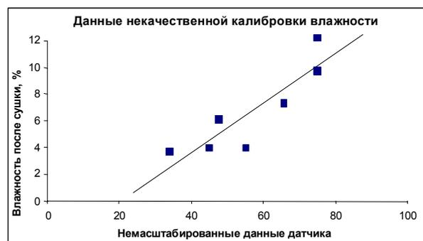
Рисунок 27. Пример ненадлежащего выбора точек калибровки материала
