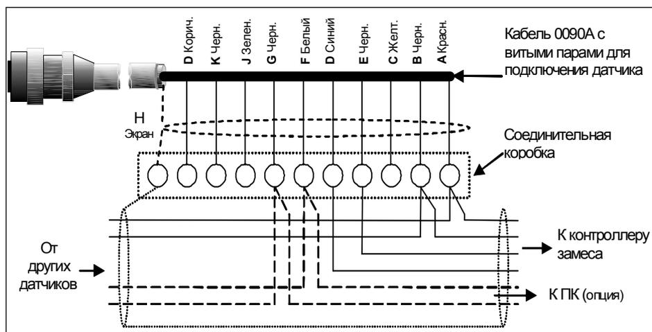
Рисунок 15. Подключение аналогового выхода.
