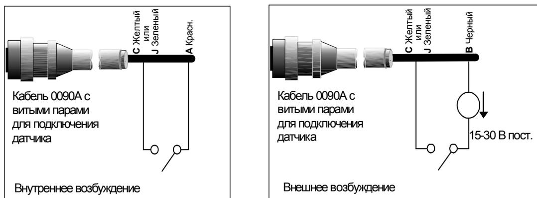
Рисунок 17. Внутреннее/внешнее возбуждение цифровых входов 1 и 2
