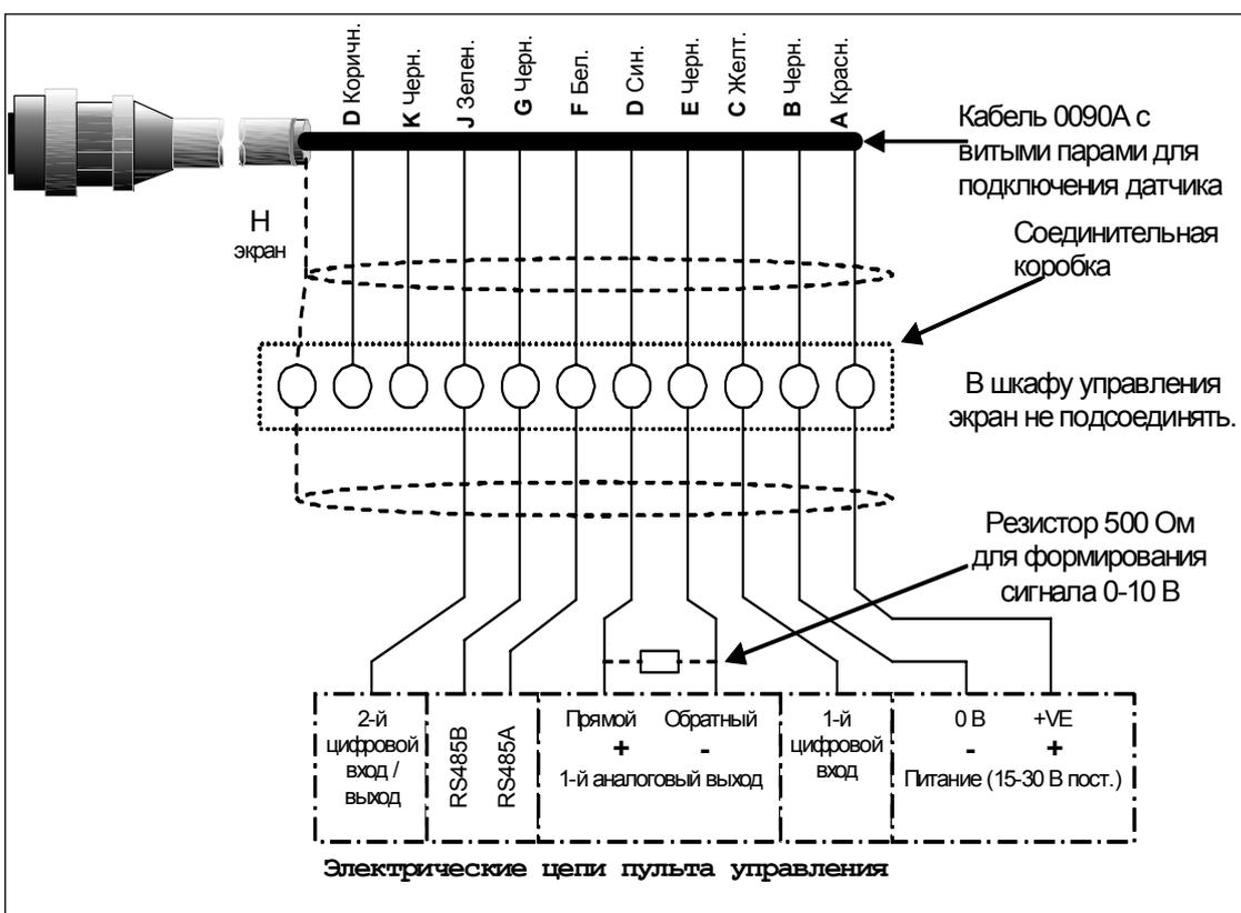
Рисунок 14. Разводка кабеля датчика
