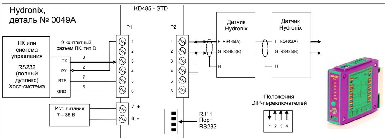
Рисунок 21. Схема подключения преобразователя RS232/485 (2)
