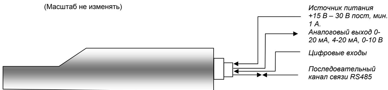
Рисунок 2. Подключение датчика (общее представление)
