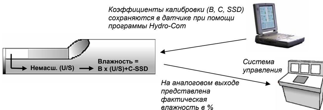
Рисунок 24. Калибровка внутри датчика Hydro-Probe II
