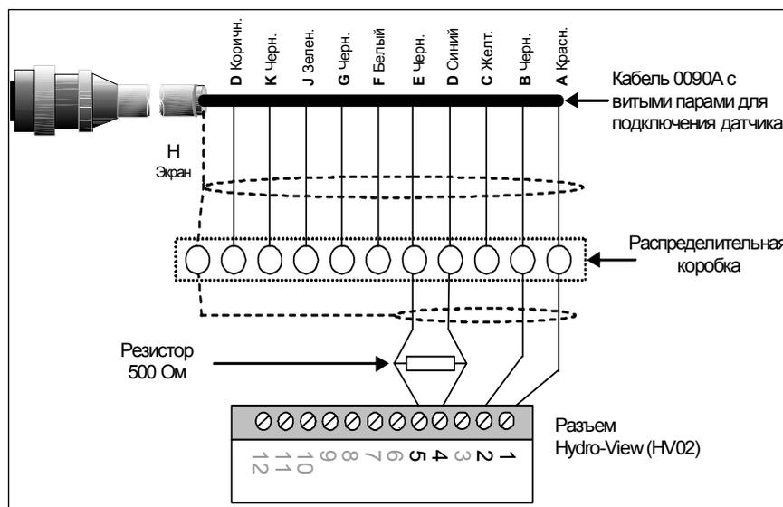
Рисунок 16. Подключение к Hydro-View.
