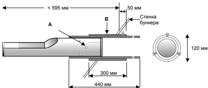
*A – Датчик крепится к внутренней гильзе 6 болтами (на резьбу болтов нанесите смазку Locktite или аналогичную).
