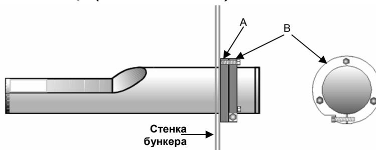
*A – К стенке бункера (толщина 12,5 мм) приваривается крепежная пластина (поставляется заказчиком)
