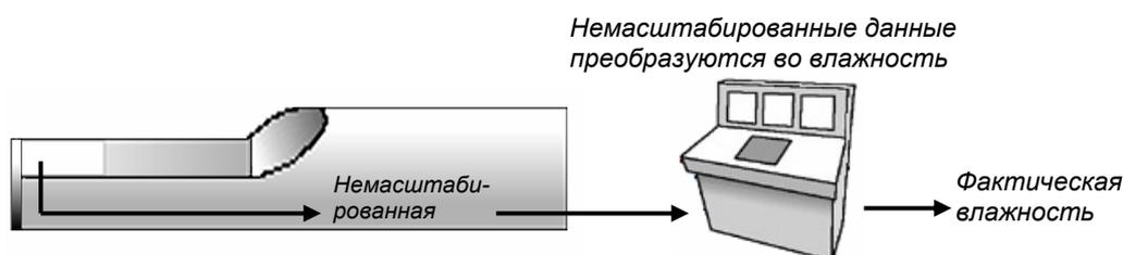
Рисунок 25. Калибровка внутри системы управления
