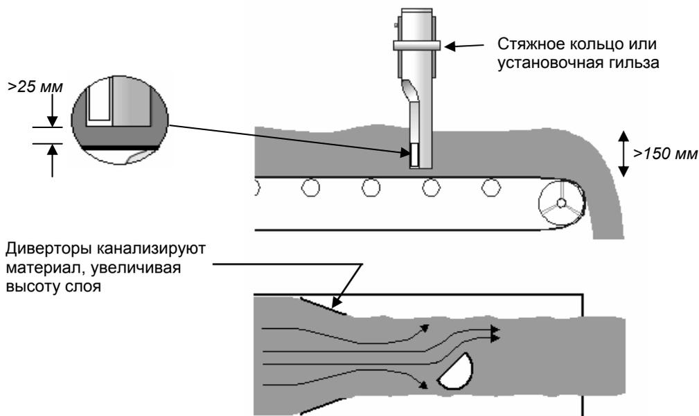
Рисунок 10. Монтаж датчика Hydro-Probe II на ленточном конвейере
