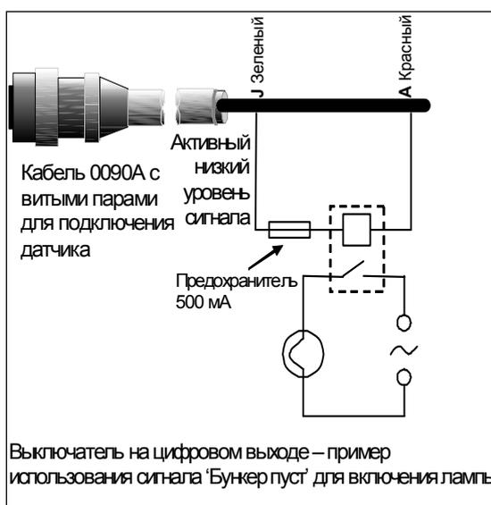
Рисунок 18. Активация цифрового выхода 2
