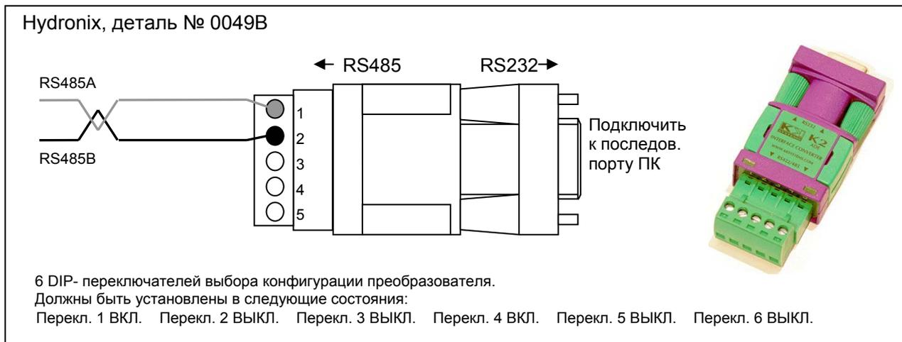
Рисунок 20. Схема подключения преобразователя RS232/485 (1)
