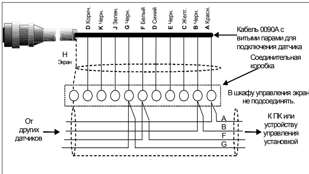
Рисунок 19. Многоточечное подключение по интерфейсу RS485
