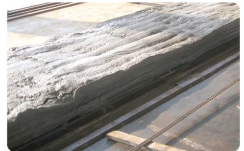
图 2：由于稠度不一致导致空心混凝土构件塌陷示例
