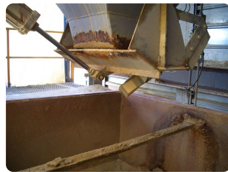
Sonde installée sous une trémie
