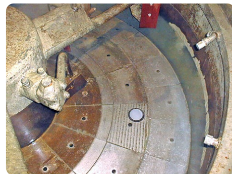
Sonde installée dans un malaxeur
